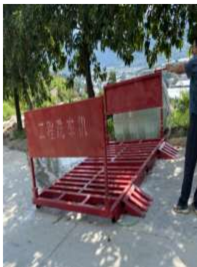
图 4-18 车辆冲洗装置
